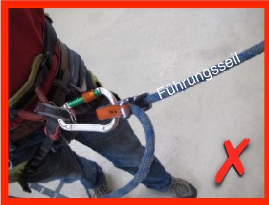
Seil falsch eingelegt!
