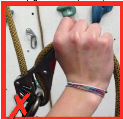
Le bec du smart est trop haut (ligne du dispositif)
