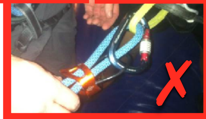
Corde mal installée, cas réel survenu en Allemagne.
