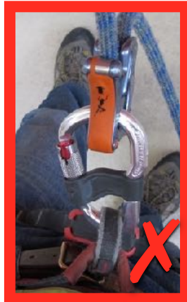
Click-Up avec un mousqueton inadapté. Seuls les mousquetons recommandés par le fabricant doivent être utilisés.
