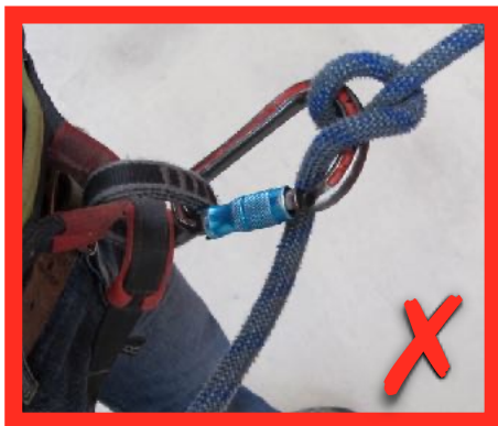
Demi-cabestan avec un Twistlock (ainsi que fermeture du côté de la main de freinage)!
