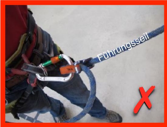
Seil falsch eingelegt!
